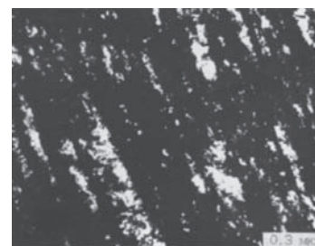
Рис. 2. Темнопольное изображение микроструктуры никелида титана после деформации прокаткой на 50%, \times 66000
